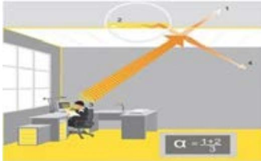
Las propiedades absorbentes de sonido de un material se expresan en el coeficiente de absorción de sonido,  $\alpha$ , (alfa) en función de la frecuencia.  $\alpha$  oscila de 0 (reflexión total) a 1.00 (absorción total).
