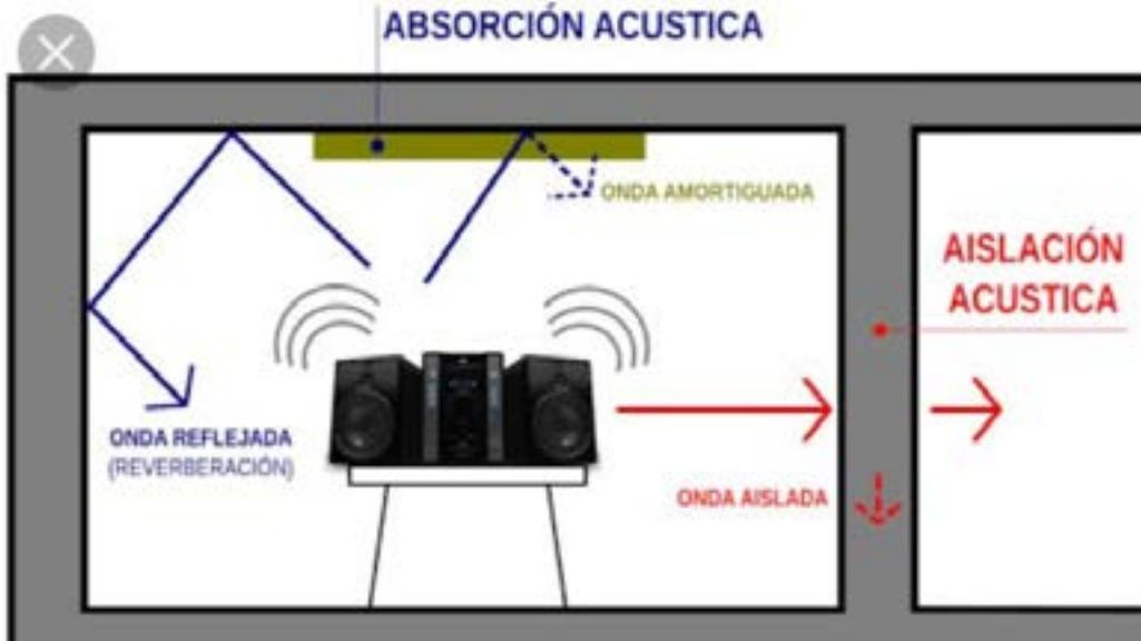
Fig. 3 Arquitectura para absorción y aislamiento y manera de transferencia del sonido.
