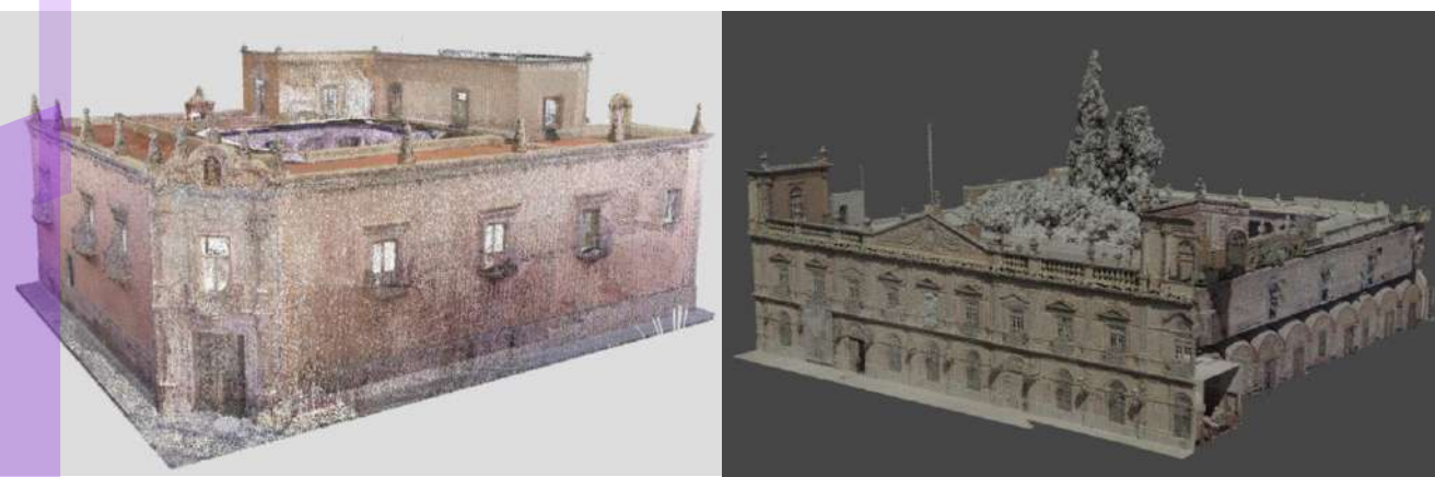
Figura 1. Maquetas digitales con nubes de puntos (Caja Real y Excolegio jesuita, SLP), con escaner 3D.
